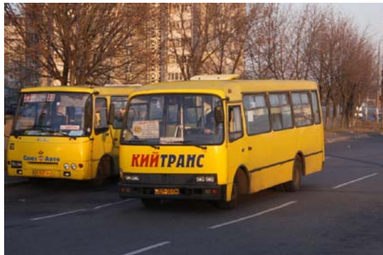
Київ: мікроавтобус з українським кузовом на шасі для вантажних фургонів, з двома автоматичними дверима для пасажирів, спеціально розроблений і здатний забезпечувати швидкі та багаторазові перевезення
